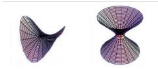
Figure 5 - Surfaces à courbure négative : col, hyperboloïde à une nappe.
